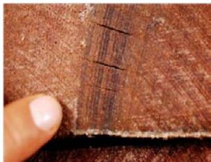
**Figure 21: Collapse (effondrement cellulaire)**
