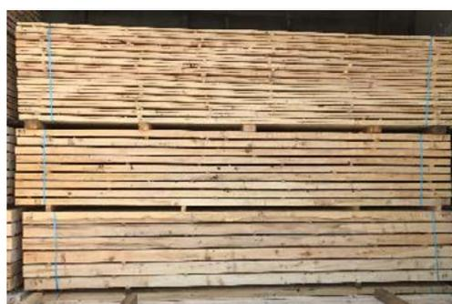
La superposition des baguettes n'est pas effectuée correctement.
