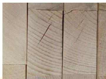
**Figure 20 : Fentes en bout sur du Hêtre en sortie de séchoir** (CRITTBois, 2018)
