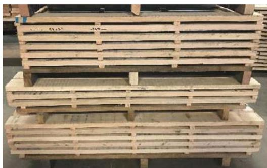
Les espacements sont précis et la superposition des baguettes correctement effectuées.
